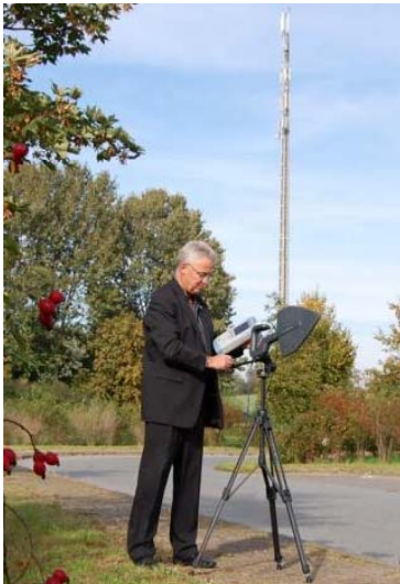
Abb.3 Messung LTE-Frequenzen (Foto: A.Runge, ZV eGo-MV)
